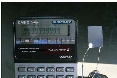
以太陽能電池為動力的計算器及其內部所使用的矽晶片（右）
